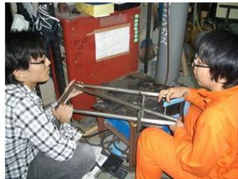
溶接グループでは等価構造計算書を製作するのに必要な比較実験用のパイプフレームの一部を製作しました。初めに溶接を行うためのパイプの擦り合わせをしました
