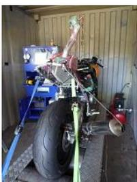
TG04 に搭載していた吸排気の性能を測るためにエンジンベンチを行いました。また、そこでスポンサー様である YSP 豊橋南の加藤社長よりエンジンの出力向上に関するアドバイスを頂きました。
