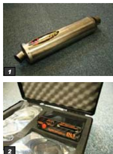
1. サイレンサ 排気抵抗の低減と騒音レベルの削減の両立を目指します。 2. データロガー GPS センサと加速度センサにより、車両の挙動を把握します。データに基づいた客観的なセッティングを行うことが出来ます。
