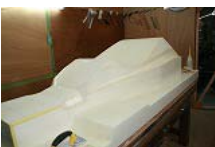
5軸加工機で加工された雛型を樹脂でコーティングします
