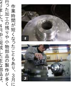
1. ハブのスプライン加工 ワイヤ放電加工により行います。 2. ベルクラウクの加工 半自動NCフライス盤が活躍します。 3. ハブの旋盤加工 ベアリングとの嵌合部は百分の一mm代の精度が求められますが、最終的には視物合わせが一番です。
