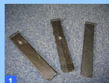
1. CFRP 製ペダル試作品。
