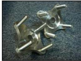
上/アルミ製のハブ。材質の変更もさることながら、NC加工による形状の変更も軽量化に寄与しています。
