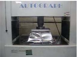
インパクトアツテネーターの破壊試験
