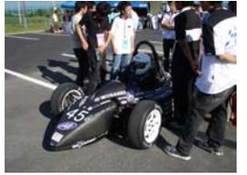
昨年車両の270 kgから200 kgという大幅な軽量化目標を達成するため、部品一つ一つの重量の削減目標を設定し、部員一人丸ごと軽量化を推進しました。この結果、4気筒エンジン搭載車としては世界的に見ても最軽量クラスの車両となりました。大幅な軽量化を実現するため、解析ソフトウェアの積極的な利用、CFRPの導入を行いました。
