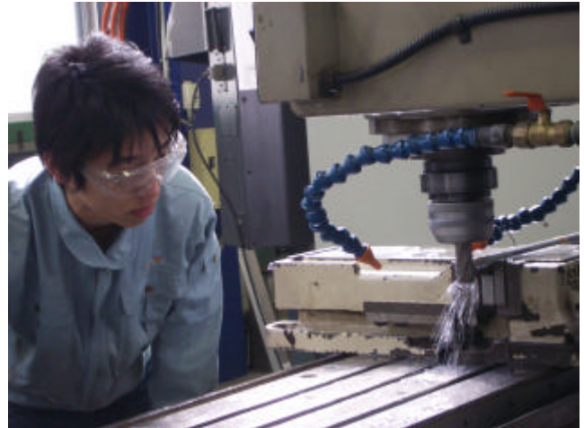
フレームの端面出し
